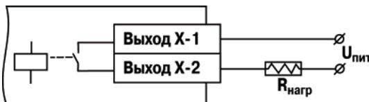
Рис. Б.17. Схема подключения к выходному элементу типа Р
