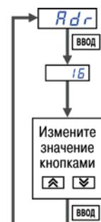
Рис. 9.5. Схема изменения значения параметра
